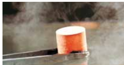
Раскаленный цилиндр из камня Mammutti погружают в протечную воду температурой 20 °C.
