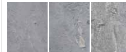
Сорта горшечного камня с более крупной кристаллической решеткой подходят для таких частей печи, температура в которых не поднимается выше 450 градусов.
