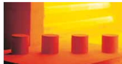
Цилиндры из камня Mammutti, нагретые до температуры 940 °C.
