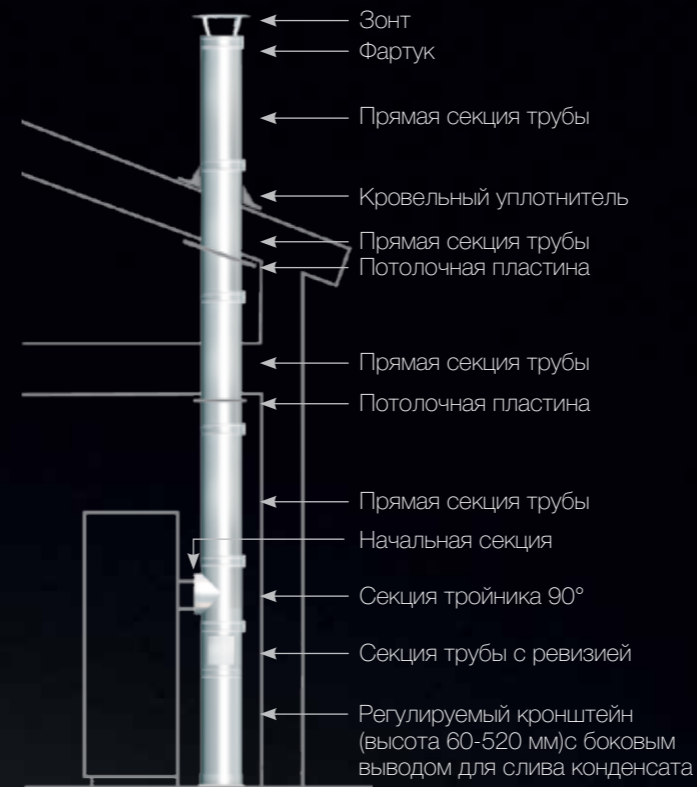
Внутренний монтаж сзади
