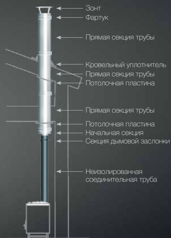
Монтаж с неизолированной соединительной трубой
