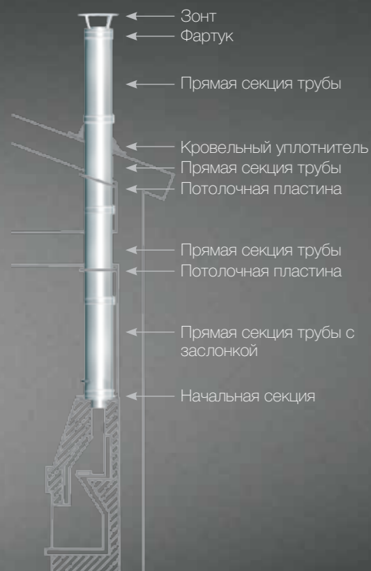
Монтаж сверху камина
