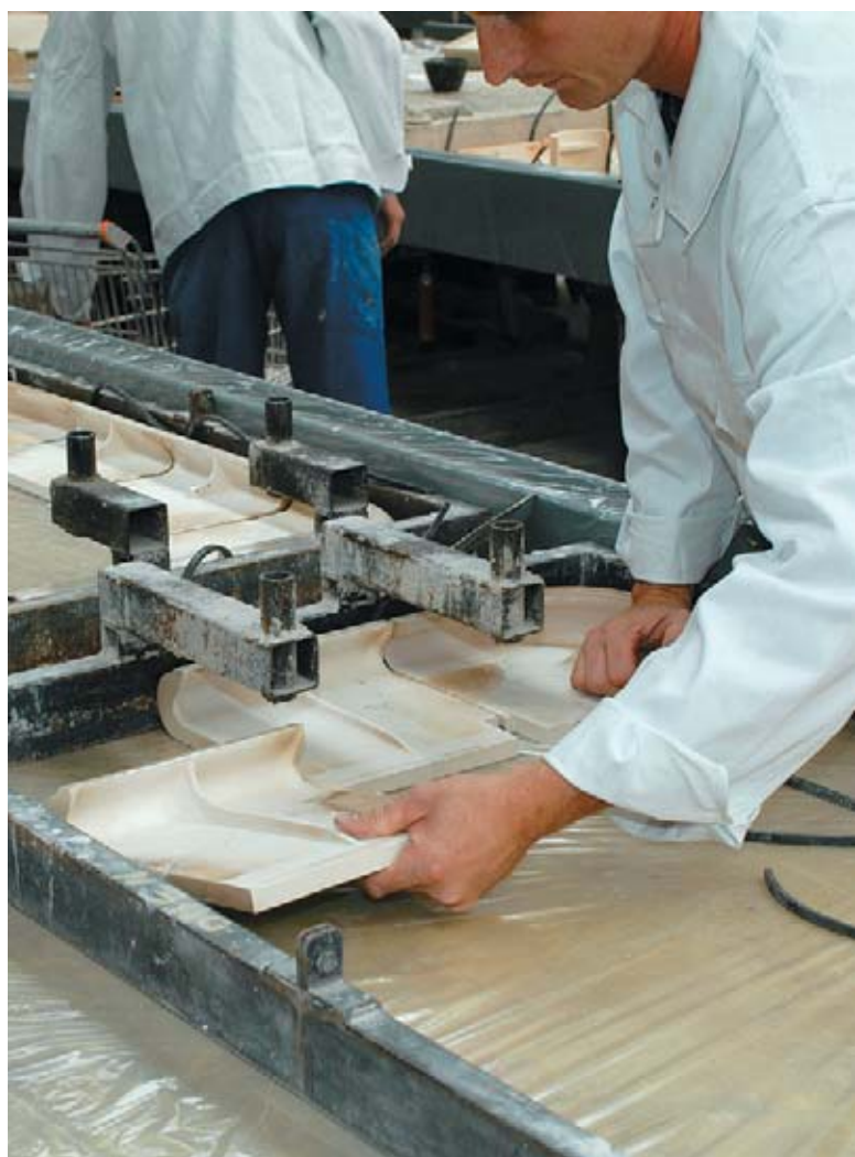
Bei der Vorfertigung der Kaminmodule ist viel Handarbeit gefragt.
