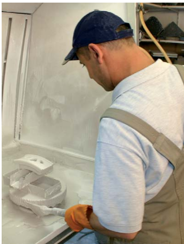
Das Glasieren der Kacheln erfordert viel Erfahrung. Auf jede Kachel muss exakt die gleiche Glasurmenge aufgebracht werden.
