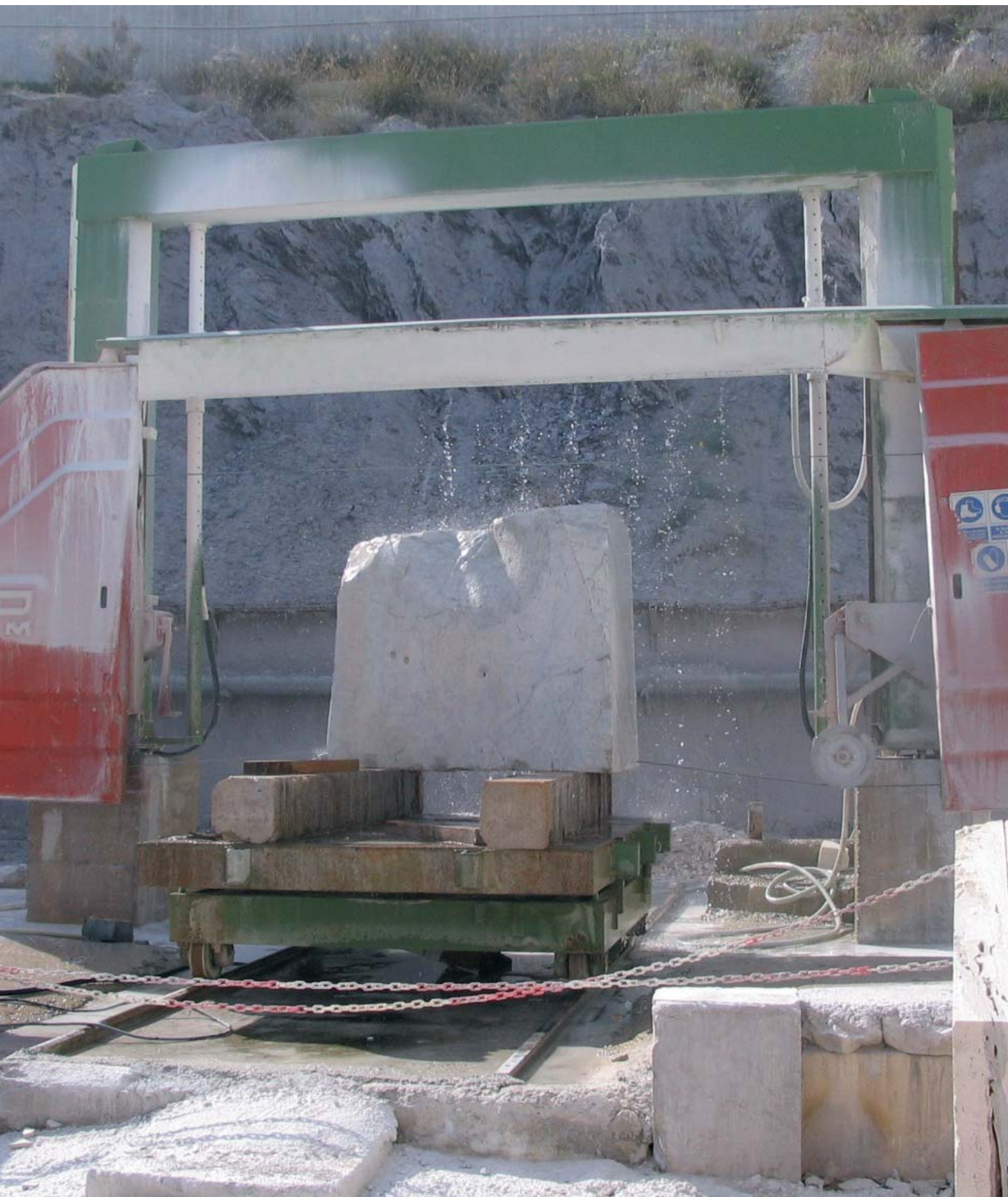
Seilsägen schneiden die großen Marmorblöcke in kleinere Stücke und Platten.
