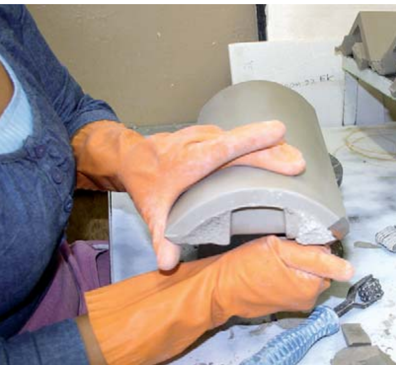
Nach dem Ausformen muss jeder Kachelrohling von Hand verputzt werden. Hier werden alle Gießnähte entfernt.
