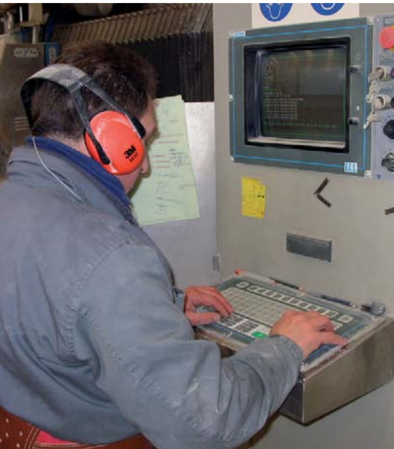
Hier wird die CNC-Maschine programmiert, die die Konturen in den Marmor fräst.
