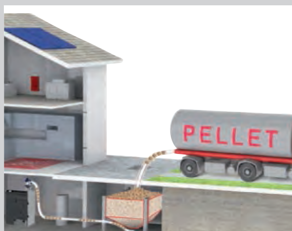
Esempio di approvvigionamento pellet tramite autobotte
