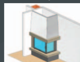
Implantation idéale lorsque le conduit se trouve de l'autre côté (dans la cuisine par exemple)
