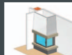
Implantation qui consiste à prolonger une cloison en épi pour recréer un angle
